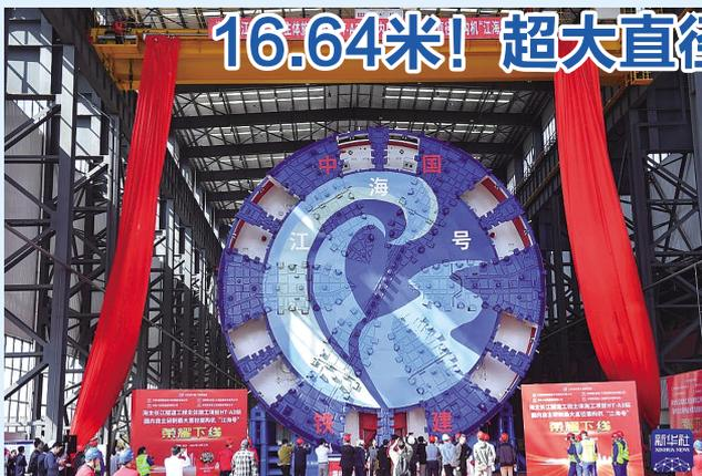
10月31日,国内自主研发、最大开挖直径达16.64米的超大直径盾构机在湖南长沙下线,将被用于目前全国最长公路水下盾构隧道——海大长江隧道施工。这台盾构机取名为“江海号”,由中国铁建重工集团、中铁十四局集团联合打造,整机长约145米,总重量约5000吨。
